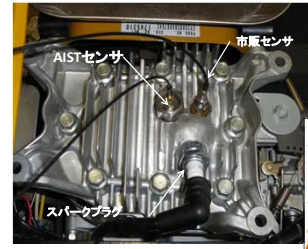
図 センサを取付けた4サイクルエンジンの外観
