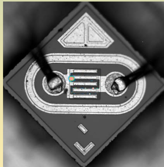
図2 バイポーラトランジスタ 逆バイアスブレイクダウン発光
