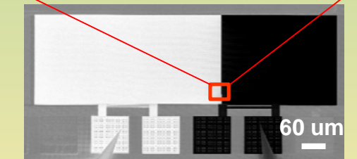
図3 差動アンプによる高抵抗不良観察
